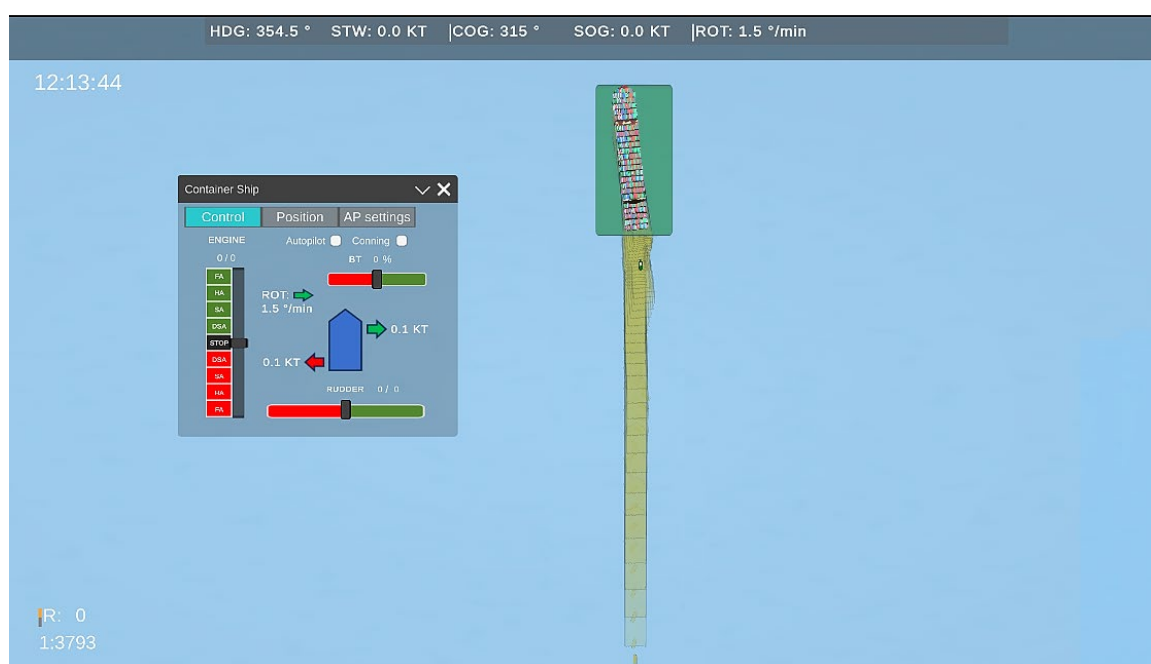
Рисунок 5.16 – Вид зверху: фінальний етап моделювання гальмування великотоннажного контейнеровоза за допомогою кормового буксира в режимі непрямого буксирування з прогнозуванням траєкторії
