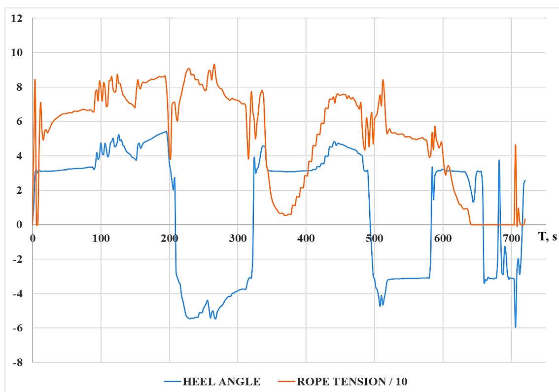
Рисунок 5.17 – Графік значень кутів крену ( ^\circ ) буксира при певному значенні натягу на буксирному тросі (т/10) впродовж моделювання
