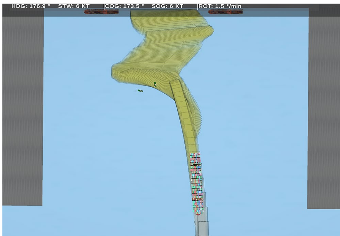
Рисунок 5.28 – Вид зверху: моделювання виходу великотоннажного контейнеровозу і гавані після віддачі обох буксирів
