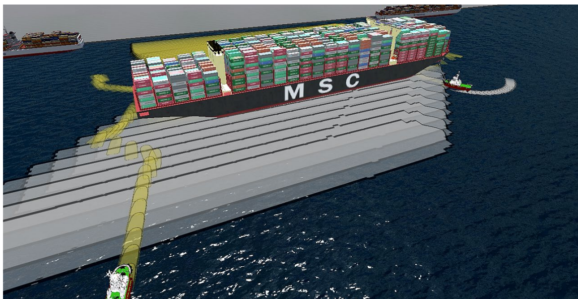
Рисунок 5.24 – Моделювання маневрування судна з буксирами: відхід від причалу з прогнозуванням траєкторії – кормовий буксирний трос відданий
