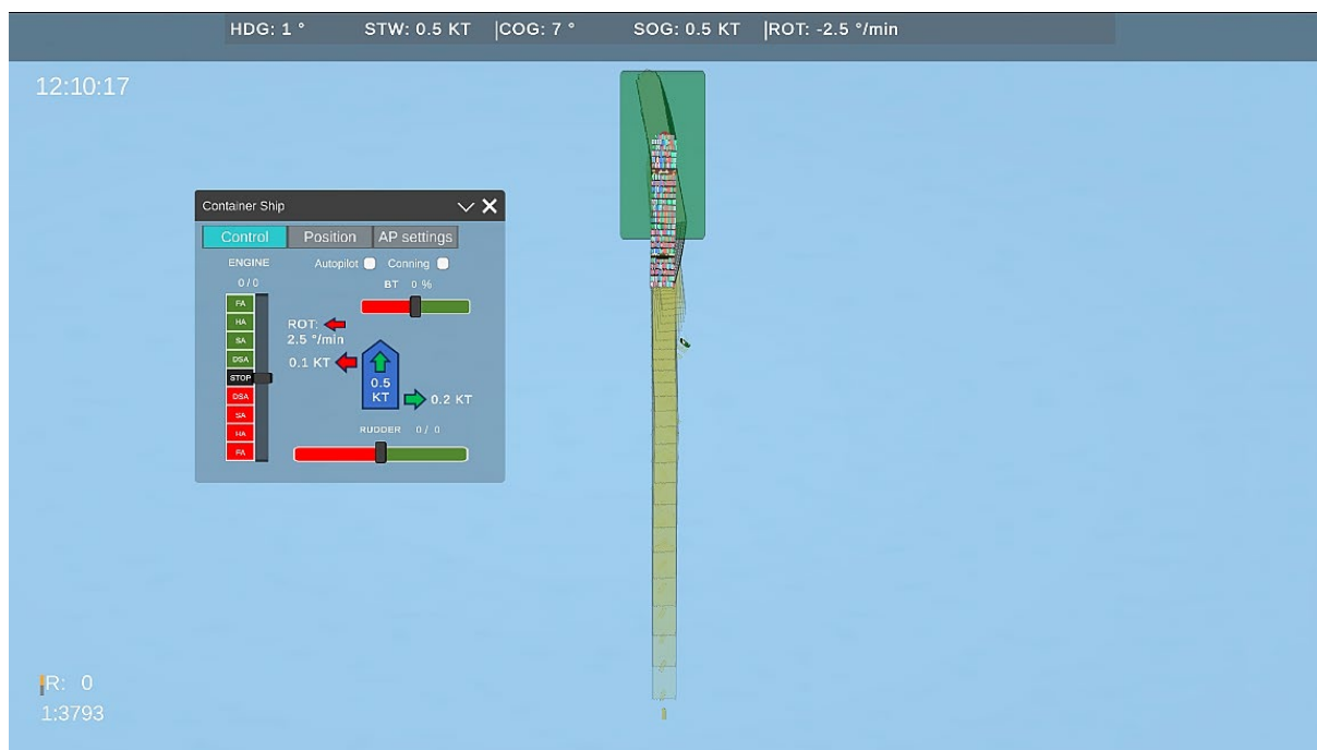
Рисунок 5.15 – Вид зверху: етап корекції кутової швидкості судна в процесі гальмування за допомогою непрямого буксирування
