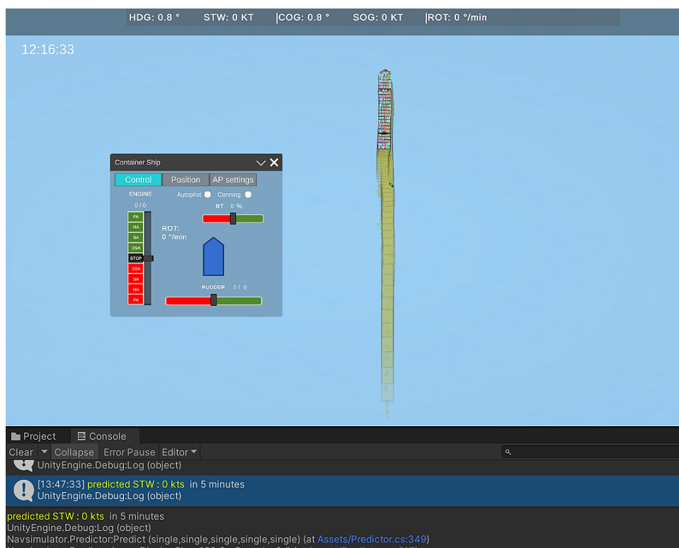
Рисунок 5.21 – Вид зверху: моделювання гальмування судна за допомогою кормового буксира з прогнозуванням траєкторії – судно зупинено
