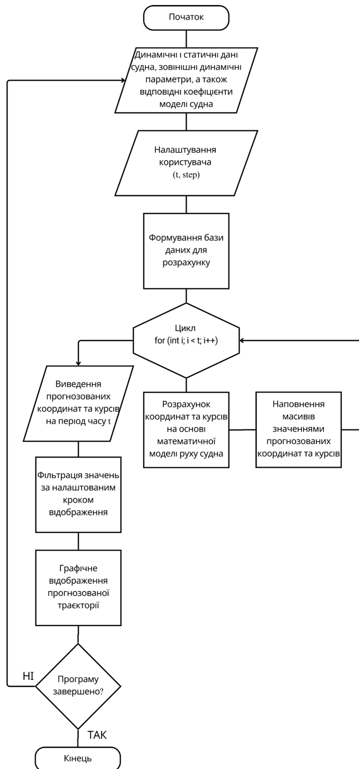
Рисунок 4.1 – Блок-схема алгоритму розрахунку прогнозованої траєкторії на основі математичної моделі
