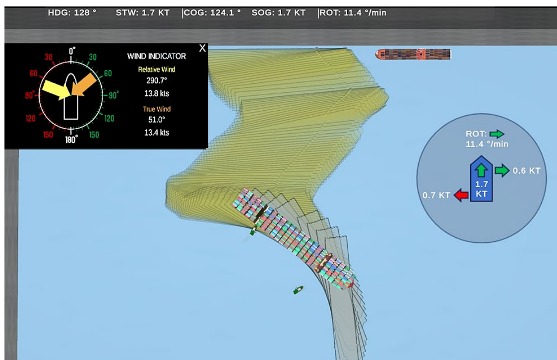
Рисунок 5.25 – Вид зверху: моделювання процесу повороту великотоннажного контейнеровоза за допомогою двох буксирів, один працює у режимі штовхання, інший – у режимі тягання
