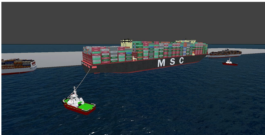
Рисунок 5.22 – Моделювання відходу великотоннажного контейнеровоза від причалу за допомогою буксирів в режимі реального часу
